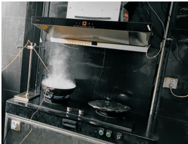
图 12 油烟机积油测试装置
